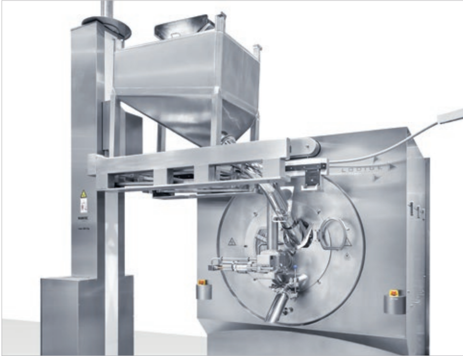
Befüllung des Coaters mittels Hubsäule
